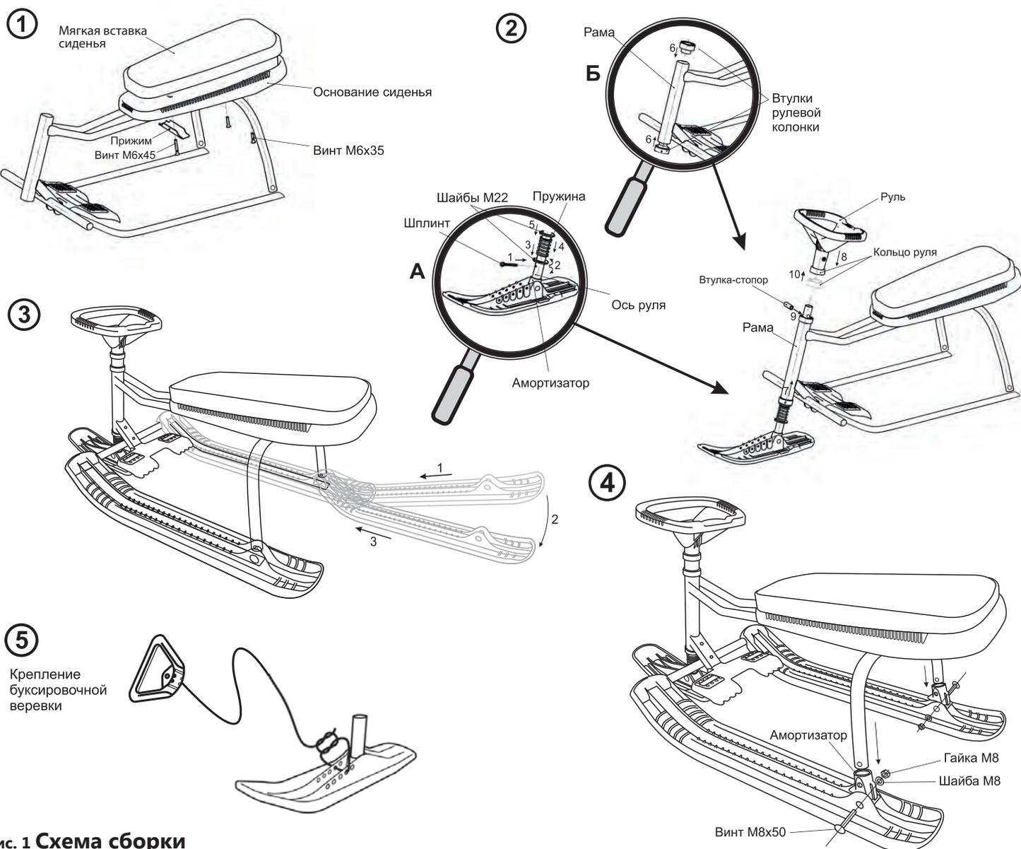
рис. 1 Схема сборки
